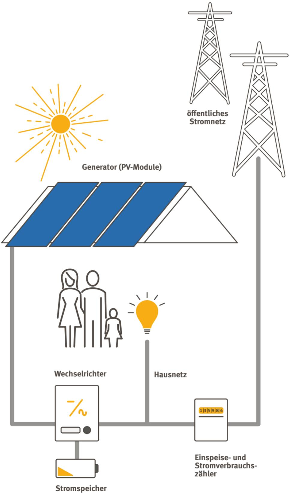
Photovoltaik-Anlage mit Eigenverbrauch
